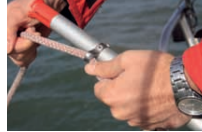
Şamandıradan ayrılmak için tonoz halatını kılavuz mapasının içine yerleştirin.
