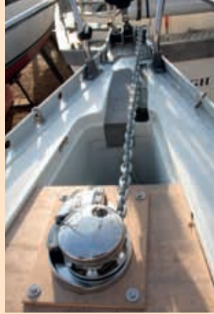
Yerleştirdiğimiz kontrplak, ırgatları, zincirin rahat akmasını sağlayacak şekilde monte etmemizi sağladı.
