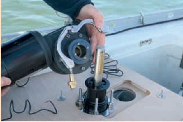
Lewmar'ın, dişli kutusuna uyan, iyi ve hızlı bir bağlama-çözme sistemi var.
